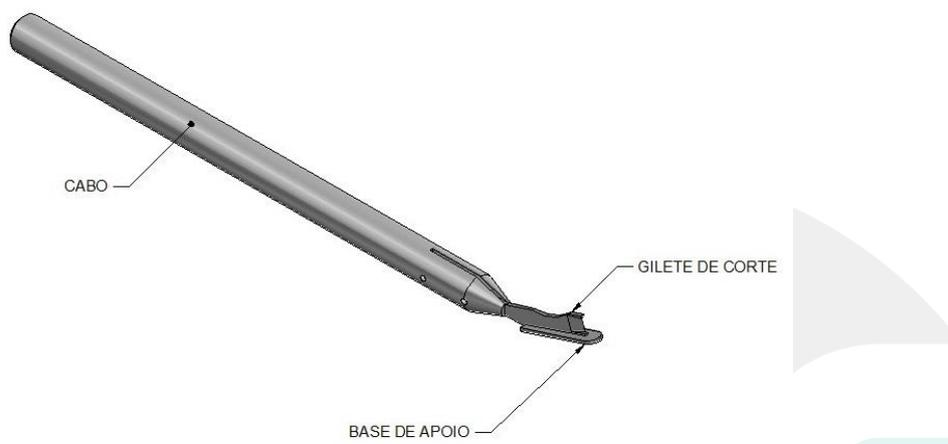
**CABO:** Consiste em um cabo de alumínio liga 6351 anodizado, com diâmetro de 155 mm
